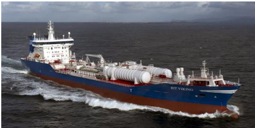
Рисунок 11: Танкер Bit Viking, переведенный на использование СПГ
